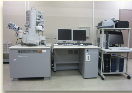
電界放出型走査型電子顕微鏡 S-4800 (日立ハイテクノロジーズ)
