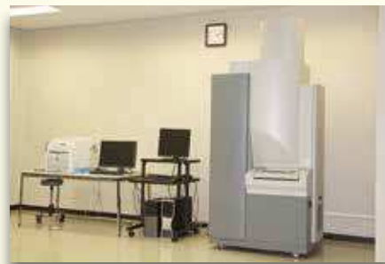
マトリックス支援レーザー 脱離イオン化飛行時間型 質量分析計 4800 MALDI TOF/TOF Analyzer (アプライドバイオ システムズ)
